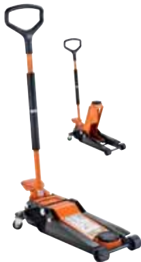
Garagedomkraft av aluminium 1,5 ton Lägsta/högsta höjd 85/375 mm. Längd 530 mm. Vikt 13 kg. 40-8842 ..... 1499:-
