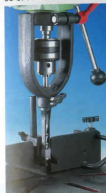
Ståmborrtillsats. Kraftig komplett sats som monteras på en pelarbormaskin med hälsmått 40, 55, 60, 66 eller 75 mm. Innehåller: Hållare för ståmbör, ståmbör 6,4, 8,0, 9,5 och 12,7 mm samt justerbar fastsättningsanordning för arbetsstycket. 30-8500 ..... 729:--
