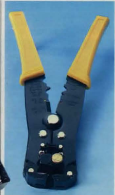
Kabelskalare . Skalar automatiskt en eller flera ledare med area 0,13-6,0 mm 2 . Ställbart skaltryck. Kan även användas vid pressning av kabelskor och som avbitare. 20-3837 ..... 98:-
