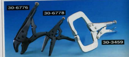
Svetsstänger av stål med smidda härdade käftar. Sjävläsande med utlösingsarm. Nr Längd / max grip. Pris 30-6776 250mm/40mm ..... 46:- 30-6778 165mm/50mm ..... 40:- 30-3459 280mm/95mm ..... 49:-
