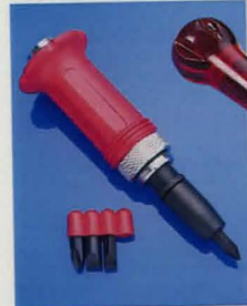
Slagskruvmejsel , ställbar för kraftig i eller urdragnin av skruvar och muttrar, t. o. m. fastrostade. Utbytbara spårklingor 8, 10 mm breda och kryssmejslar nr 2 och 3. Dessutom kan vanliga hylsor med 1/2" fyrkantfäste infästas istället för klinghållaren. Mycket kraftig konstruktion. Vikt 1 kg. 30-2023 ..... 69:- Reservklingor för slagskruvmejsel 30-2023. Sats om 4 olika. 30-5573 ..... 29:-
