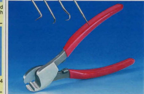
Kabeltång av härdat verktygsstål. Specialslipade käftar för enkel kabelskalning. Plastade skänkler för bra grepp. Längd 160 mm. 30-7685 ..... 89:-
