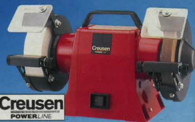
Bänkslipmaskin Creusen DS 7150TS med i det närmaste vibrationsfri gång. Motor 230 V/260 W. Varvtal 2800 v/min. Levereras med vit specialskiva (bredd 40 mm, diam. 150 mm) för slipning av eggverktyg, samt smärgelskiva (bredd 20 mm) Vikt 8 kg. 30-7212 ..... 1598,-
