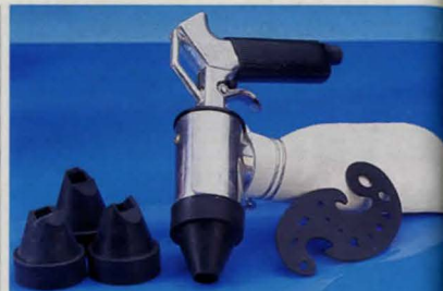
Blästerpistol med slutet system - ger snabb och dammblästring. Avlägsnar gravrost ända in till metallen på några sekunder med minimal förbrukning av blästermedel. Luftbrukning 100 - 500 l/min. Anslutning R 1/4". Levereras med st olika munstycken samt 1 st mall för blästring på plana ytor. 30-4146 ..... 298:-
