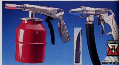
Sandblästerpistol. Behållare i av aluminium med bjonettfästning. Arbetstryck 6-8,5 bar. Munstycke 4,5 mm. Luftförbrukning vid 6 bar 170 l/min. 30-3903 ..... 149:-
