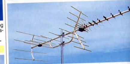
TV-antenn KOMBI med 46 element. TV1 (kanal 5-12) och TV2, TV4 (kanal 21-69). Förstärkning 9 dB resp. 12 dB. Mastfäste och anslutningsdosa f. koaxialkabel medf. Längd 225 cm. 42-4105 ..... Pr st 495:- ..... 10 st 3445:-
