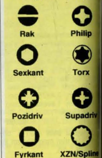
Hylsmejsel med böjligt skaft för slangklämmor. 6-kant hylsa. Nr Dim. Pris 20-2898-7 7 mm 39:00 De vanligaste skruvspår:
