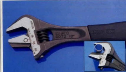
Förskiftnyckel Bahco med ergonomiskt handtag klätt med termoplastmaterial med halkfri yta. Förvandlas med ett enkelt handgrepp till rörtång genom att löparen skruvas ut och vänds. Gripvidd rörtång 5-35 mm / skiftnyckel 0-33 mm. Lossar enkelt även "runddragna" muttrar. Längd 257 mm. 30-4988 ..... 239:00
