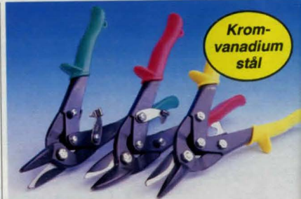
Plåtsax med utväxling för större klippkraft. Fint tandade skär i kromvanadiumstål. Skänklar av pressad stålplåt med plasthandtag. Längd 250 mm.
