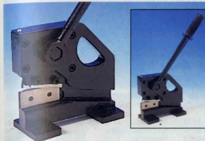
Plåtsax av stål för bänkmontage. Klipper upp till 2,5 mm plåt i obegränsad längd. Kraften överföres från hävarmen via excenter, vilket ger parallell rörelse av skäret och maximal kraft. Vändbara knivar, längd 75 mm med fyra skär. Mätt exkl. arm 180x85x180mm. Vikt 6,5 kg. 30-5421 ..... 298:00
