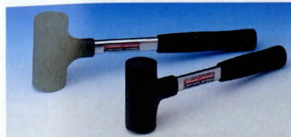
Studsfri hammare med huvud av mjuk Uretan som eliminerar slagmärken och behåller sin form även efter slag mot hårda ytor och skarpa kanter. Stålskaft med gummi grepp. Stålkulor i huvudet ger maximal slagverkan och eliminerar rekyl.
