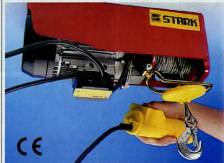
Elvinsch 100 kg kraftig utförande för lyft och drag. Fäste för montering på rör 50 mm diam. eller fyrkant profil 45 x 45 mm. Manövrering via manöverhandtag med 1,8 m sladd. Automatiskt stopp vid helt indragen lina. Levereras med 11m 2,5 mm wire, brytblock och anslutningsladd med stickpropp. Med enkel lina lyftes max 100 kg upp till 12 m, hastighet 9 m/min. Med dubbel lina lyftes max 200 kg upp till 5 m, hastighet 4,5 m/min. Motor 230V/430W. Mått 366x155x200 mm. Vikt 10 kg. 40-5608 ..... 1450:00
