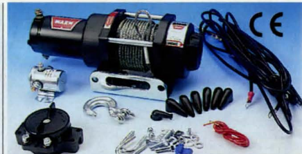
Elvinsch 12 V WARN A2000 kraftig modell med styrgrind. Lämplig för montering på 4-hjuliga terrängmotorcyklar eller universell användning. Löst reglage för montering på lämplig plats. Koppling ger möjlighet att frikoppla och dra ut wren för hand. Arbetslast 907 kg enkel lina. 15 m stålwire diam 5 mm. Hastighet / strömförbrukning obelastad 7,1 m/min / 15 A, fullast 2,1 m/min / 145 A. Mått 33 x 12 x 12 cm. Vikt 11 kg. Levereras med överbelastningsskydd. 40-5694 ..... 3395:00
