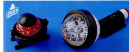
SILVA STAR 58. Den idealiska kompassen för mindre båtar och bilar. Fast eller löstagbar montering, vertikalt, horisontalt, sluttande eller i taket. Inbyggd belysning (12 V) och kompensator. Stabil 360° skala, vikt 165 g. Avläsning sker direkt mot det främre styrstrecket.
