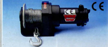
Elvinsch 12 V WARN U1000 kraftig modell med reglage monterat på vinschen. Arbetslast 454 kg enkel lina. 9 m stålwire diam. 5 mm. Hastighet/strömförbrukning obelastad 9 m/min / 20 A, fullast 6 m/min / 280 A. Mått 33 x 14 x 14 cm. Vikt 7,5 kg. Levereras med överbelastningsskydd. 40-5693 ..... 2395:00
