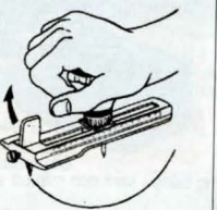
Hålskärare för upptagning av hål i mjuka material som porösa träskivor, plast, papp, läder, tyg, gummi mm. Stållbar för 40-210 mm håldiam. Levereras med 3 reservblad. 30-2634 ..... 159:00
