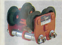
Löpvagn för max last 1 ton, passar l-balk. Spårvidd 58-130 mm. Vikt 10,5 kg. 30-3746 ..... 795:—
