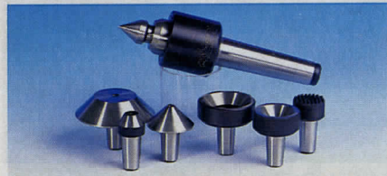
Roterande centrumdubb med utbytbara spetsar. Satsen innehåller 6 spetsar + utdrivarkil. Dubben är nål- och kullagrad. Tål 260 kp beslagning. MK3. 30-3482 ..... 1395:--
