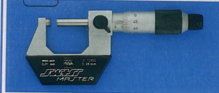
Mikrometer med analog avläsning. Mätområde 0-25 mm. Noggrannhet 0,01 mm. Härdade mätytor, spindel-lösning. Mätspindel diam. 6,5 mm. DIN 863. 30-4722 ..... 595:--
