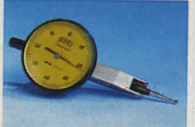
Mätur . Precisionsinstrument graderat 1/100 mm. Mätområde 10 mm. visaren går ett varv pr mm. Vridbar gradering o. ställbara toleransmärken. Kapsel, diam. 57 mm, av kraftig förnicklad mässing. Standardfäste, diam. 8 mm. Finns även med fästöra på baksidan. 30-1277-2 standard .. 210:— 30-1277-1 med fästöra. 210:—
