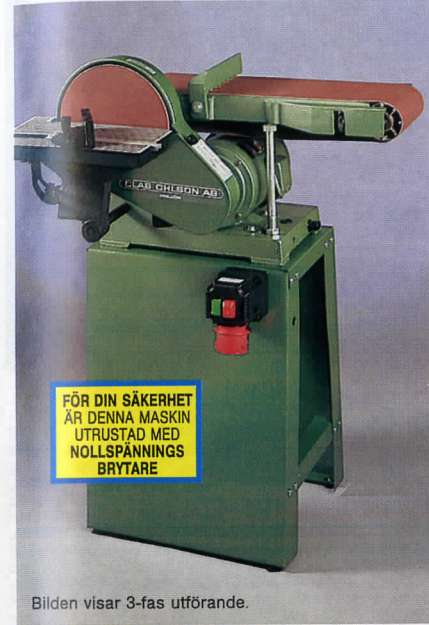
Bandslip med 225 mm sliptallrik. Kraftig modell med stativ av gjutjärn. Bandaggregatet ställbart 0 - 90°. Bordet vid sliptallriken kan även monteras vid slipbandets kortsida. Slipband 150 x 1220 mm. Motor 3-fas 220/380 V, 0,75 kW försedd med 0-spänningsutlösare och strömbrytare med inbyggd 5-poligt CEE uttag. Vikt 52 kg. Levereras med ställbart slipbord, geringslinjal samt golvstativ. Strömbrytare och golvstativ är omonterade. 40-4143 ..... 2995:— Bandslip lika ovan, men med 1-fas 220 V motor. 40-4348 ..... 3495:—
