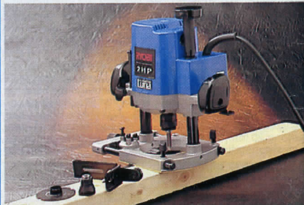
Handöverfräs RYOBI R-501. Specialmaskin för inrednings- och möbelsnickeri. Trestegsanslag för förhandsinställning av 3 olika fräsdjup. Tomgångsvarv 22000 v/min. Effekt 1500 W. Vikt 5 kg. Levereras med spännhylsor för 6, 8, 12 och 16 mm skaftdiam. sidoanslag med fininställning, rullanslag, schablonplatta, nycklar samt 1 st hårdmetallfräs. 30-2505 ..... 2195:—
