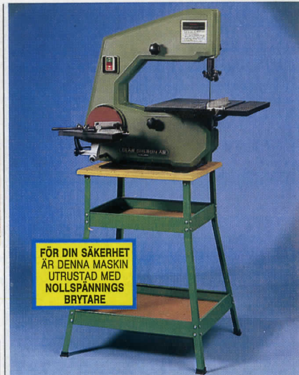
Bandsåg med tre hjul för största möjliga sågdjup. Ram av vridstiv stålprofil. Stabilit sågbord, ställbart 0-45°. Kullgrade hjul diam. 170 mm. Dubbla bladledare med kullager som stödrullar. Tre bladhastigheter: 120 m/min för metall, 750 m/min för trä/plast, 1200 m/min för bandslipning. Uttag för spånsug diam 32 mm. Sågens totala höjd är 650 mm, bredd 750 mm. Bordets storlek 400 x 400 mm. Avstånd sågblad - stativ 360 mm. Såghöjd max 145 mm. Sågbladets längd 1783 mm. Levereras med: motor 220V/410W samt strömbrytare med 0-brytare. (Skydds form IP44) klyvlinjal, geringslinjal med djupanslag, cirkelsågningslinjal, profilsliptillsats, planskiva (diam 150 mm) med ställbart anhåll. Vikt inkl. motor ca 30 kg. 40-3175 ..... 2295:—
