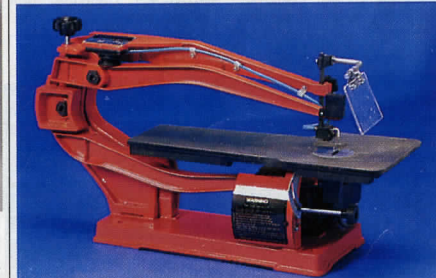
Kontursåg. Kraftig gjuten konstruktion. Hög matningskapacitet. Bordet ställbart 0-30°. Inbyggd spånblåsning. Max såghöjd 45 mm, sågdjup 450 mm. Bladlängd 125-130 mm. Bladets hastighet 1720 slag/min. Motor 220 V/95 W. Nettovikt ca 27,5 kg. 40-3558 ..... 1795:— Reservbladssats , 5 st per förp. 20-4321 ..... 29:50
