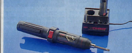
Sladdlös skruvdragare SKIL Super Twist med utbart 3,6 V batteri. Laddningstid 3 timmar. Höger- och vänstergång, automatisk spindelåsnings för att dra svåra skruvar för hand. Levereras med laddare och vägghållare samt två dubbla bits (kruss + spår). Vikt 0,5 kg. 30-4844 ..... 389:--
