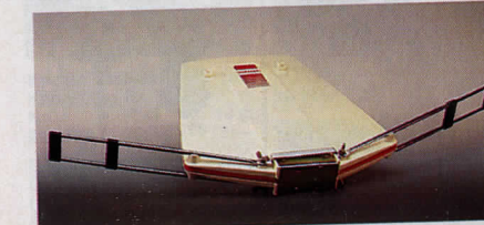
Husvagnsantenn. Kombiantenn med aktiv förstärkare för kanal VHF 2-12 och UHF 21-69. Förstärkning 15-26 dB. Mastfäste. Längd 40 cm. Drivspänning 12 V DC. Lev. med delningsfilter, 6 m koaxialkabel och spänningskabel. Försedd med stickpropp för cigarettändaruttag. 32-3619 ..... 365:—
