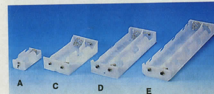
Batterihållare av plast med kontaktfjädrar och plats för seriekoppling av 1,5 V stavbatterier. För typ R20. A med lödron. Övriga med tryckknappsanslutning.
