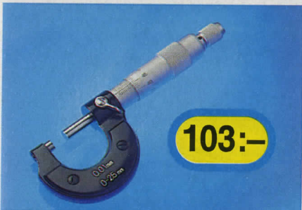
Mikrometer med hårdmetallmätor — diam. 6,5 mm. Mattförokromad mättrumma — diam. 17 mm, med friktionsanordning och låsning. Isolerbrickor mot handvärme. Avläsning 0,01 mm. Kontrollmått medföljer vid mätområde över 25 mm.
