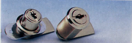
Cylinderlås förnicklat med rosett, fallregel med 90° rörelse. Kan användas både som höger- och vänsterlås. Cylinderdiam. 16,5 mm, längd 21 mm. Regellängd från centrum 30 mm. Mått grundplatta: 42 x 16,5 x 2 mm.
