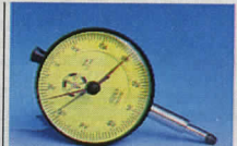
Mätur . Precisionsinstrument graderat 1/100 mm. Mätområde 10 mm. visaren går ett varv pr mm. Vridbar gradering o. ställbara toleransmärken. Kapsel, diam. 57 mm, av kraftig förnicklad mässing. Standardfäste, diam. 8 mm. Finns även med fästöra på baksidan. 30-1277-2 standard .. 210:— 30-1277-1 med fästöra. 210:—
