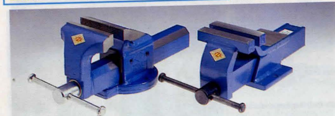
Skruvstycke med sänksmida induktionshårdade stålbackar. Induktionshårdad städ och slid. Patenterat system för ansättning av slid. Inkapslad trapetsgångad spindel. (Levereras utan rörbackar och vridplatta.) Nr Bredd/spännvidd Vikt Pris 40-2840 100/140 mm 7 kg 755:-- 40-2841 125/170 mm 11 kg 894:--
