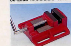
Maskinskruvstycke av gjutjärn. Backbredd 65 mm. Spännvidd 75 mm. Vikt 1,8 kg. 30-3680 ..... 79:--
