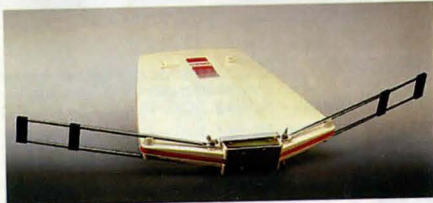
Husvagnsantenn. Kombiantenn med aktiv förstärkare för kanal VHF 2-12 och UHF 21-69. Förstärkning 15-26 dB. Mastfäste. Längd 40 cm. Drivspänning 12 V DC. Lev. med delningsfilter, 6 m koaxialkabel och spänningskabel. Försedd med stickpropp för cigarettändaruttag. 32-3619 ..... 320:—
