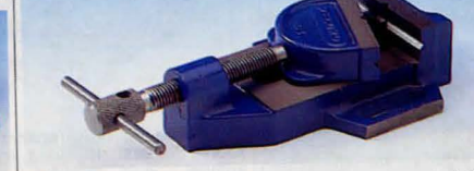
Maskinskruvstycke av gjutjärn. Praktisk konstruktion med rörlig käft, svängbar för koniska arbetsstycken. Frästa V-spår i backarna. Pass för bänkbormask av standardtyp. Backbredd 75 mm, spännvidd 65 mm. Vikt 2,6 kg. 30-1882 ..... 398:--
