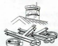
Skorstensfäste. Dubbelt fäste för 2" antennmast. Kraftig och gediget utfört och korrosionssäkrat helt varmgalvaniserat. Det är enkelt o. snabbt att montera och sitter säkert. Bandlängd 2 x 5 m. 32-1069 ..... 108:—
