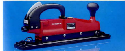
Planslipmaskin för finslipning av stora plana ytor. Vibrationsfritt tvåhandsgrepp med luftreglering i handtaget. Snabbfäste för slippapperet. Slipp Plattans diam. 65 x 390 mm. Varvtal 3000 v/min. Vikt 2,7 kg. Nr 30-3218 ..... 395:—
