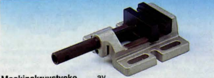
Maskinskruvstycke av gjutjärn med polerade prismabackar av stål. Backbredd 85 mm, spännvidd 65 mm. Vikt 3,6 kg. Nr 30-1206 ..... 249:-- Maskinskruvstycke lika föreg. men backbredd 100 mm, spännvidd 90 mm. Vikt 4,5 kg. Nr 40-2425 ..... 298:--
