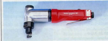
Plättnibblingsmaskin för tunnplåt. Ger ett helt "rent" skär. Kapacitet stålplåt 1,2 mm, aluminiumplåt 1,5 mm. Nibblingshastighet ca 1,5 m/min. Spårbredd 3 mm. Ansl. gänga inv. R 1/4". Vikt 1 kg. Nr 30-3308 ..... 385:— Nr 20-3426 Reservstans ..... 19:50 Nr 20-3599 Extra dyna ..... 64:—
