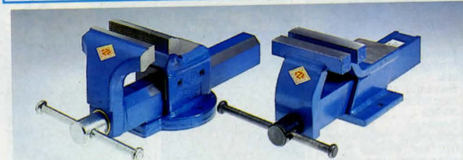
Stålskruvstycke i mycket hög kvalitet med städ. Induktionshärdade backar, bredd 110 mm. Ansättningslid. Trapetsgångad spindel. Vikt 7 kg. Nr 40-3169 ..... 377:-- Vridplatta passar till Rörbackar till skruvstycke. 30-2842 100 mm 237:-- 40-2840-2841 30-2843 125 mm 286:-- 30-2844 89:50
