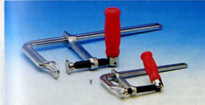
Skruvting för höga späntryck. Profilerad skena av seghärdat stål. Kulledd tryckbricka. Trapetsgångad spindel med vikbart plasthandtag för högt åtdragningsmoment.
