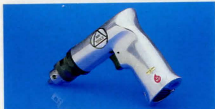
Borrmaskin. Levereras med 10 mm nyckelchuck. Varvtal 2500 v/min. Vikt 0,9 kg. Nr 30-2793 ..... 295:— Borrhuck 10 mm med nyckel. Passar tryckluftsmaskiner. Nr 20-3346 ..... 69:—
