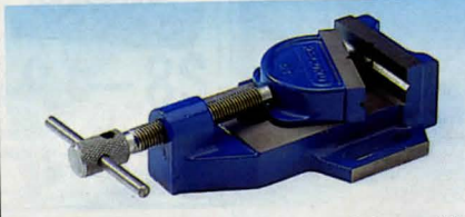
Maskinskruvstycke av gjutjärn. Praktisk konstruktion med rörlig käft, svängbar för koniska arbetsstycken. Frästa V-spår i backarna. Pass för bänkbormask av standardtyp. Backbredd 75 mm, spännvidd 65 mm. Vikt 2,6 kg. Nr 30-1882 ..... 398:--
