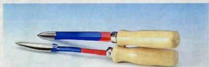
Hålpunnsats för håltagning i radiochassi, paneler mm. Tillv. av prima stål. Satsen innehåller 5 st punsar: 16, 18, 21, 25 och 30 mm, samt en brotsch 4-11 mm. Förvarat träskrin med fack. Nr 30-1766 Pr sats 379:—
