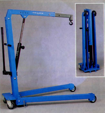
Verkstadskran , hydraulisk med utdragbar förlängningsarm. Hopfällbara ben gör att den tar liten plats vid förvaring eller transport. Armlängd/lyftkapacitet: 1000 mm/500 kg, 1100 mm/400 kg, 1200 mm/300 kg och 1300 mm/200 kg. Stativets längd utfälld 1430 mm, bredd 920 mm, höjd 1520 mm. 40-4116 ..... 2990:--
