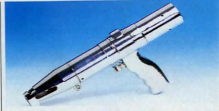
Plåtsåg för sågning i de flesta material. Framstycket vridbart 360° för god åtkomlighet. Fäste för vanliga bågfilmsblad. Slaglängd 6–32 mm. Slagtal 2200/min. Vikt 1,7 kg. Nr 30-3219 ..... 325:—
