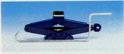
Domkraft för max 600 kg. Lyfthöjd 12 till 30 cm. Utväxling ca 200 gånger. Vikt 2,5 kg med vev. Nr 40-2207 .....Pris 95:--
