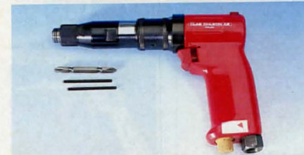
Skruvdragare pistolmodell. Utvägigt inställbar för önskat åtdragningsmoment. Höger-/vänstergång. Fäste för 1/4" klinga. Varvtal 2000/min. Min-/max åtdragningsmoment 0,35/0,69 kpm. Ansl. gänga inv. R 1/4". Returluften leds ut genom handtaget vilket ger låg ljudnivå. Vikt 1,2 kg. Nr 30-3309 ..... 545:—
