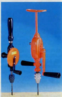
Borrskaft av prima gjutjärn med frästa kugghjul och stödhjul. 3-backs chuck för upp till 6 mm. Total längd 31 cm. vikt 0,65 kg. Tyskt fab. Nr 30-889 ..... 174:—
