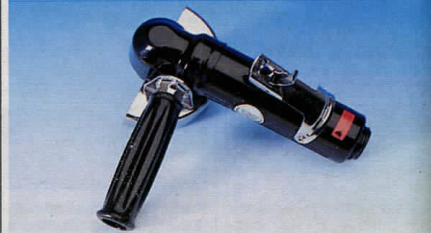
Vinkelslipmaskin för navrondeller 100 x 16 mm axelhål 16 mm. Spindelgånga UNC 3/8 x 24. Varvtal obelastad 12000 v/min. Säkerhets spärr förhindrar oavsiktlig igångsättning. Anslutningsgånga R 1/4". Vikt 1,8 kg. Nr 30-3305 ..... 695:–
