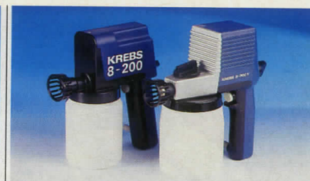
Sprutaggregat KREBS 8-200. En schweizisk kvalitetsprodukt. Vibrationspumpsystem. Cylinder av hårdast specialstål. Spruteffekt 170 g/min., viskositetseffekt 70 Din-sec. Tryck vid munstycket reglerbart. Effekt 40 W, 220 V. Färgbehållare 0,5 l. Höjd 22 cm. Med 2,4 m kabel. S-märkt. Vikt 1 kg. Nr 30-760 ..... 379:–
