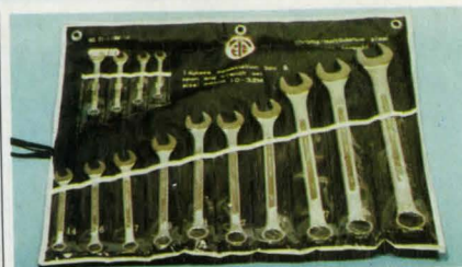
Stor blocknyckelsats med 14 st smidda och förkromade nycklar av krommolybdenstål. Gripvidder i mm-mått från 10 till 32. Längd 12–42 cm. Med fackindelad fodral. Total vikt 4,3 kg.
