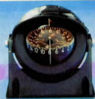
Marinkompass SILVA 70- NB. 1 kraftigt nakterhus av slagtålig ABS-plast med stälbart visir. Inbyggd be- lysning. Kan monteras i oli- ka vinklar fast eller löstag- bar (fästskenor medföljer). Kompassrosen svävar fritt vid krängning till 30° åt alla håll. Ytermått ca 10x12 cm. Vikt 0,4 kg. Nr 34-966 ..... 495:—
