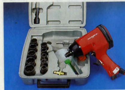
Mutterdragarsats. Reversibel rotationsriktning. Varvtal 2800 v/min. Inställbart moment. Hylsfäste 1/2". Vikt mutterdragaren 2,5 kg. Levereras i kraftig plastlåda med 10 st krafthylsor 11–27 mm, förlängare 80 mm, oljekanna, nyckel samt reservlameller till luftmotor. Nr 30-3250 ..... 475:—
