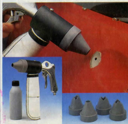
Blästerpistol med slutet system - ger snabb och dammfri blästring. Avlägsnar gravrost ända in till metallen på några sekunder med minimal förbrukning av blästermedel. Luftförbrukning 100-500 l/min. Anslutning R 1/4". Levereras med cirkulärt gummimunstycke samt blästermedel. Nr 30-3573 ..... 435:—
