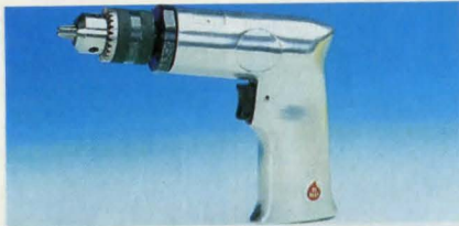
Borrmaskin. Levereras med 10 mm nyckelchuck. Varvtal 2500 v/min. Vikt 0,9 kg. Nr 30-2793 ..... 295:—
