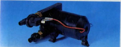
Vattenpump 12 V DC för husvagn, båt, fritidshus m. m. Självsugande ner till 1 m. Levereras med tryckströmbry- tare, pumpen startar automatiskt när vattenkranen öpp- nas. Max tryck 1,5 bar. Kapacitet ca 6 lit/min. Ström- förbrukning 4,5 A. Anslutning för 12 mm slang. (Passande slang 40-297). Storlek 14x11 cm. Nr 34-1810 ..... 548:—
