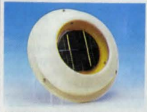
Ventilationsfläkt sol- cellsdriven för båt, hus- vagn m. m. Ingen ström- förbrukning förutom från den inbyggda solcellen. Ventil- erlar så fort solen skiner. Lock för avstängning med- följer (monteras över sol- cellen). Monteras i vägg, tak eller fönster. Monte- ringshål 120 mm. Vagg- tjocklek max 40 mm. Diam. 215 mm. Tjocklek 95 mm. Nr 35-590 ..... Pr st 265:—
