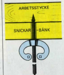
Träsnidartving , att användas vid träsnidning för fastsättning av arbetsstycket i en snickarbänk. Nr 30-570 ..... 69:--
