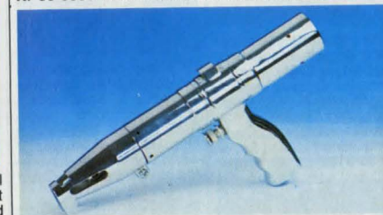
Plåtsåg för sågning i de flesta material. Framstycket vridbart 360° för god åtkomlighet. Fäste för vanliga bågfilblad. Slaglängd 6–32 mm. Slagtal 2200/min. Vikt 1,7 kg. Nr 30-3219 ..... 290:—
