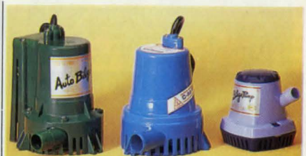
Länsump Dränkbar med automatisk nivåbrytare stälbar mellan 5 och 12 cm kan även kopplas för konti- nerlig gång. Kapacitet ca 6000 l/t. Max tryckhöjd 3 m. Drivspänning 10-15V 10A likström. Storlek 18x15 cm. Anslutning för 1"-slang.
