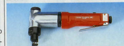
Plåt nibblingsmaskin för tunnplåt. Ger ett helt "rent" skär. Kapacitet stålplåt 1,2 mm, aluminiumplåt 1,5 mm. Nibblingshastighet ca 1,5 m/min. Spårbredd 3 mm. Ansl. gänga inv. R 1/4". Vikt 1 kg. Nr 30-3308 ..... 365:— Nr 30-3426 Reservstans ..... 15:—
