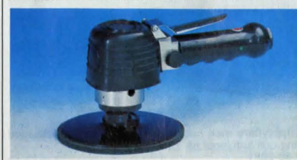
Slipmaskin med excentrerande rörelse – eliminerar "sliprosor". Slipdisk av epoxy diam. 152 mm. Varvtal 7000 v/min. Vikt 1,9 kg. Nr 30-2790 ..... 285:—
