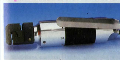
Fals/hålstansverktyg för både falsning och hålstansning med samma verktyg. Huvudet vridbart 360° för god åtkomlighet. Max plåttjocklek 1,2 mm. Falsdjup 12 mm. Håldiameter 5 mm. Anslutningsgång R 1/4". Vikt 1,2 kg. Nr 30-3518 ..... 445:—
