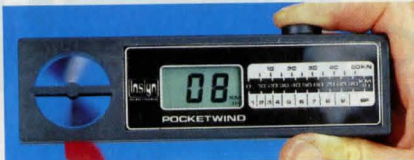
Vindhastighetsmätare i "fickformat". Visar vindens hastighet med LCD-siffror i km/t. Omvandlingstabell till Beaufort och knop finns på mätaren. Mätområde 1-100 km/t, noggrannhet 1%. Drives med 1 st medf. 9 V batteri. Nr 34-25 ..... 595:—
