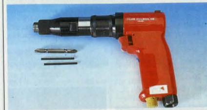
Skruvdragare pistolmodell. Utvärdigt inställbar för önskat åtdragningsmoment. Höger-/vänstergång. Fäste för 1/4" klinga. Varvtal 2000/min. Min-/max åtdragningsmoment 0,35/0,69 kpm. Ansl. gänga inv. R 1/4". Returluften leds ut genom handtaget vilket ger låg ljudnivå. Vikt 1,2 kg. Nr 30-3309 ..... 545:—
