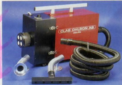
Svetsrökfilter portabelt. Avskiljer effektivt den hälsovådliga svetsröken till minst 99%. Den rena luften återcirkuleras i lokalen. Gasfilter för t.ex. asbest monterar på utloppssidan. Ljudnivå ca 63 dB (A). Mått 650x230x400 mm. Max vacuum 2 170 mm vp. Levereras med 5 m slang diam 45 mm. Svensk tillverkning. Nr Motor 220 V Luftmängd m 3 /h 40-3568-1 1 000 W 150 vid 400 mm vp 3670:— 40-3568-2 2 000 W 300 vid 400 mm vp 4970:—
