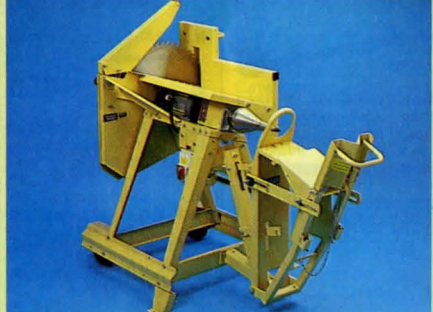
Vedkap Scheppach WS500. En stabil stålkonstruktion utförd enl. Arbetskyddsstyrelsens anv. Med hjul för enkel transport. Max skärdiameter i ett skär 180 mm (dubbel skär 360 mm). Sågvaggans längd 630 mm. Arbetshöjd 800 mm. Totalhöjd 1040 mm. Sågklingans diam 500 mm. Motor 220/380 V tre-fas. Effekt 3,0 kW med automatisk broms. Varvtal 2800 v/min. Levereras med motorskydd och nollspänningsutlösare. OBS! Klyvtillsats ingår ej. Nr 40-3294 ..... 3 780:— Klyvtillsats för WS500. Levereras enligt bild. Nr 40-3295 ..... 2 360:— Förlängare till sågvaggan. Nr 40-3296 ..... 265:—
