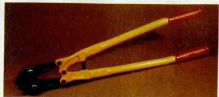
Bultsax med hejarsmitt huvud oljehärdade skär (Rockwell C 56-61). Justerbar. Skänklar av stålror med gummihandtag.
