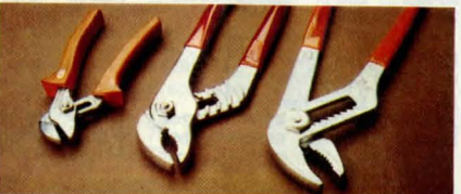
Polygriptång av förkrommat verktygsstål med plastade skänklar. Gripvidden ställbar i olika spår.
