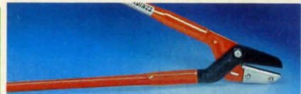
Röjsax Sandvik P17. Lätt och välbalanserad sax med teflonbehandlade skär. Klarar sly och grenar upp till 45 mm. Nr 30-2796 ..... 159:—
