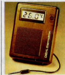
Termometer SCHWILLE. Batteridriven digitaltermometer med tydlig 12,5 mm LCD-display. Känselkroppen, vatten- och korrosionskyddad, har en 40 cm lång ledning, som kan lindas ihop inuti lådan till önskad längd. Försedd med strömbrytare. Vid kontinuerlig drift varar ett batteri 2000 timmar. Mätområde: -50° till +120°C. Toleranser: -50° till 0°, ±1°, 0° till 80°, ±0,5°, 80 till 120°, ±1°C. Storlek 120×60×22 mm. Nr 34-562 ..... 270:— (Pass. batt.: 1 st 32-2216)
