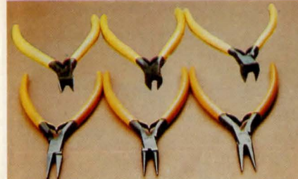
Precisionstänger för elektronik och finmekanik. Med dubbel led och bladfjäder. Blanka huvuden och handtag med PVC-isolering. Längd 115 mm. Nr 20-2231 Sidavbitare ..... 69:50 Nr 20-2232 Avbitartång ..... 74:— Nr 20-2233 Do med bett i 45° ..... 77:50 Nr 20-2234 Flackstång ..... 56:— Nr 20-2235 Böjtång ..... 56:— Nr 20-2236 Spetstång ..... 56:—
