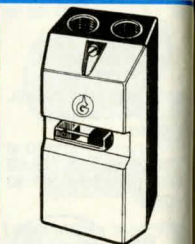
Motorskydds brytare GÖRLITZ , i sköjtätt utförande. Max 500 V. Med termiskt motorskydd. Passande tätningshylsa i in- och utgång 22,5 mm (22-1246). S-märkt. Nr Inst.omr. Pris 32-1581 1,0-1,6 A 112:- 32-1582 1,6-2,5 A 112:- 32-1583 2,5-4,0 A 112:- 32-1584 4,0-6,3 A 112:- 32-1585 6,3-10 A 112:-
