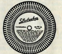
Stroboskop M 596, varvtalsmätare för grammofoonvisar 33, 45 och 78 varv/minut. 0: 30
