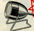
Mikrofon M 610, dynamisk med löstagbart stativ. Liten och praktisk mikrofon, lämplig för många olika användningsområden. Diam.: 1 1/2". Känslighet — 62 dB. Impedans 2000 ohm. Med sladd. 15: 90
