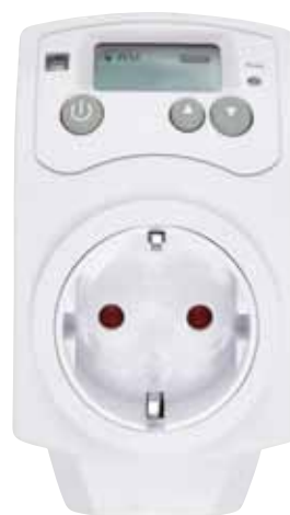
Temperaturvakt. Med frostvakt. Temperaturområde 5-30 °C/ ± 1 °C. Mäter temperaturen och styr vägguttaget. Koppla in en värmefläkt eller element. Justerbart av- eller påslag vid uppnått värde. För inomhusbruk. 230V/16A. 36-1181
